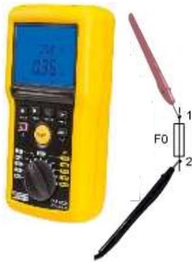
1<sup>er</sup> On souhaite vérifier l'état d'un fusible. On sort le fusible de son porte fusible puis on place les pointes de mesure de l'Ohmmètre entre les deux bornes du fusible. Ce principe est valable pour d'autre matériel (fil, contact, pole de contacteur, de disjoncteur...) en les isolant du circuit dans lequel ils sont mis en œuvre (débrancher au moins une borne du matériel).
